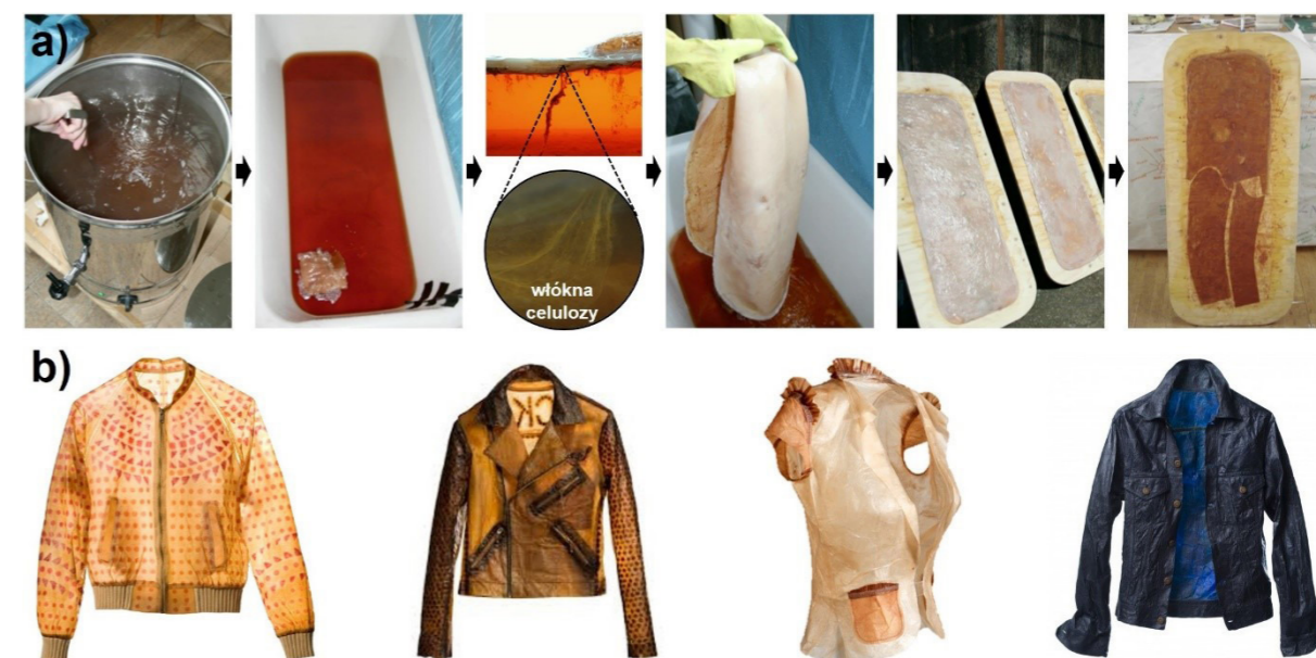
Rys. 4. Przebieg procesu produkcji bakteryjnej celulozy (a) oraz przykłady wyrobów odzieżowych z niej wykonanych (b)
